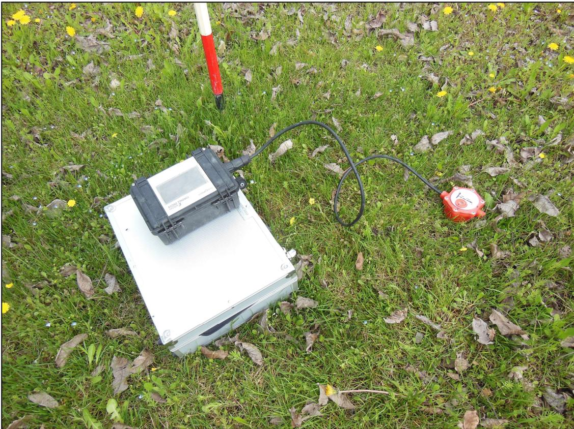
**Figura 16:** Tromometro digitale: centralina e geofono a tre componenti.
