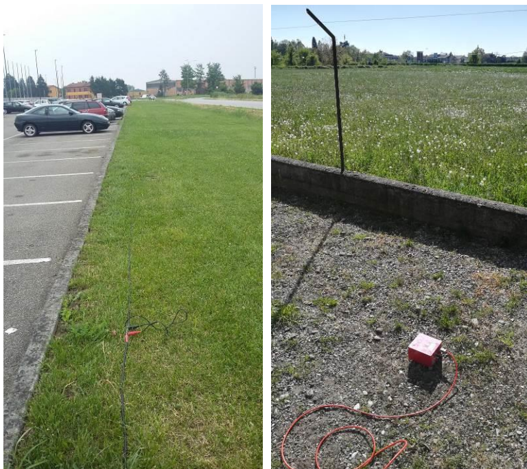
Figura 11.1. Stendimento sismico (a sinistra) e acquisizione HVSR (a destra).
