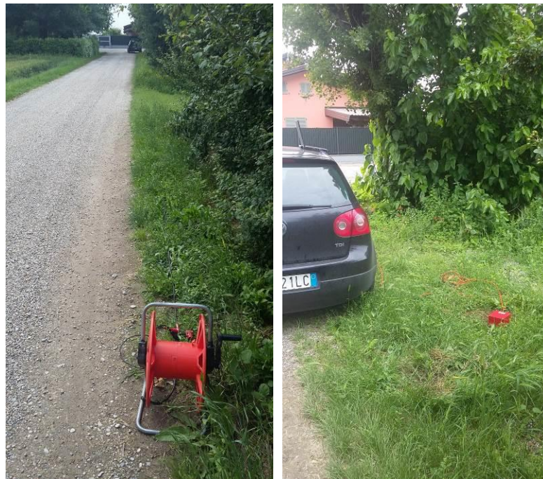
Figura 11.6. Stendimento sismico (a sinistra) e acquisizione HVSR (a destra).
