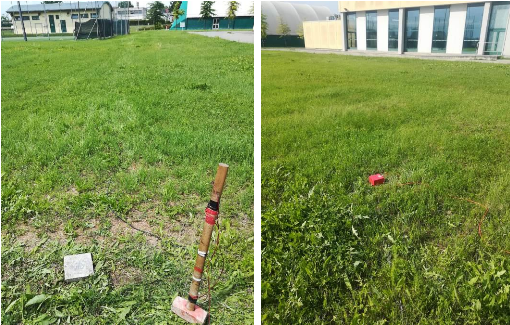
Figura 11.6. Stendimento sismico (a sinistra) e acquisizione HVSR (a destra).
