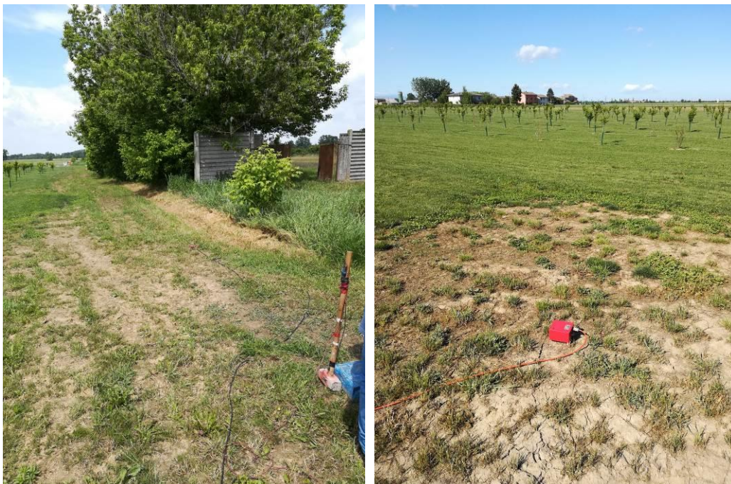
Figura 11.16. Stendimento sismico (a sinistra) e acquisizione HVSR (a destra).
