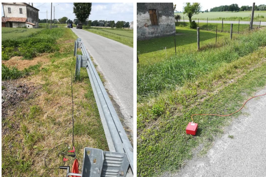
Figura 11.21. Stendimento sismico (a sinistra) e acquisizione HVSR (a destra).
