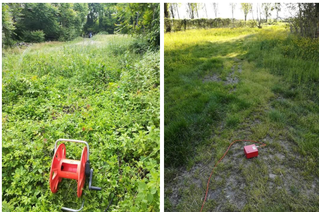
Figura 11.26. Stendimento sismico (a sinistra) e acquisizione HVSR (a destra).
