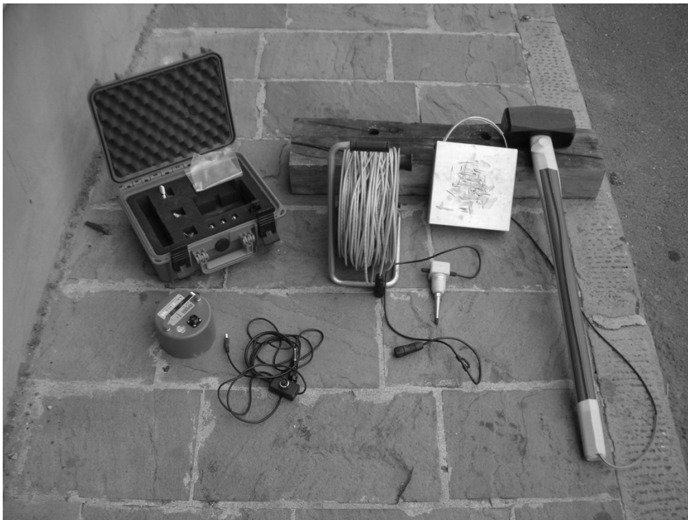
Figura B. 2 - Versione "GEMINI MASW" impiegata per la prospezione sismica attiva: Lo stendimento prevede il collegamento della strumentazione procedendo da sinistra verso destra. In aggiunta va inserito il PC come per una normale acquisizione HVSR.
