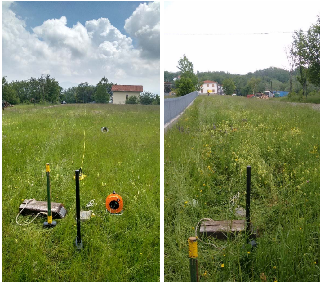
Figura A. 1 - Stendimento sismico MASW realizzato in corrispondenza dell'area di studio.
