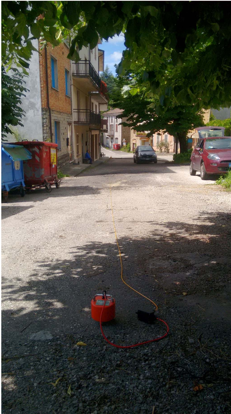
Figura A. 2 - Acquisizione HVSR realizzata in corrispondenza dell'area di studio.
