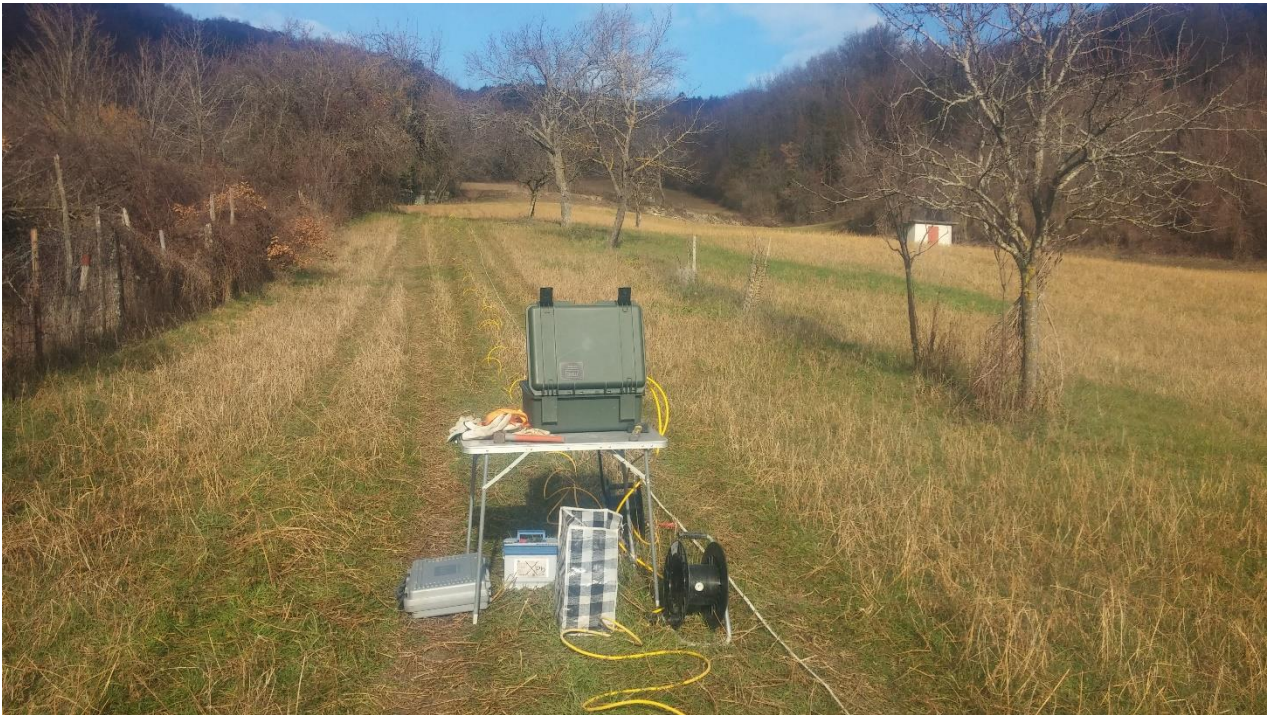
Fig. 4 - Fotografia eseguita durante la stesa dei cavi geoelettrici
