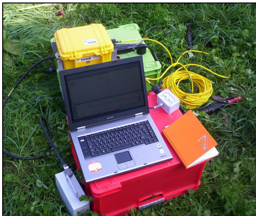
Figura 2: Strumentazione utilizzata per la prova MASW.
