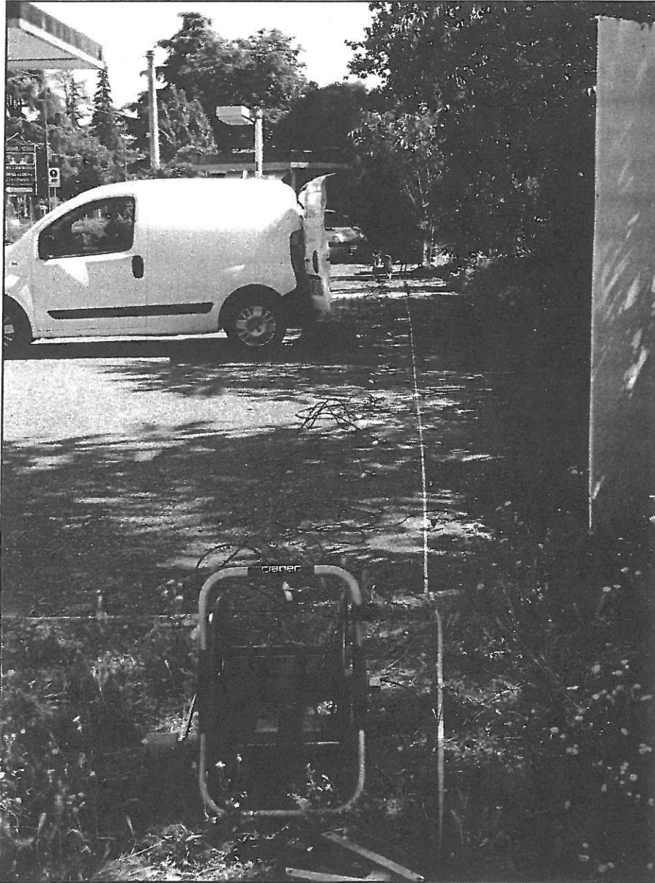
Figura 3: Vista dello stendimento MASW effettuato.
