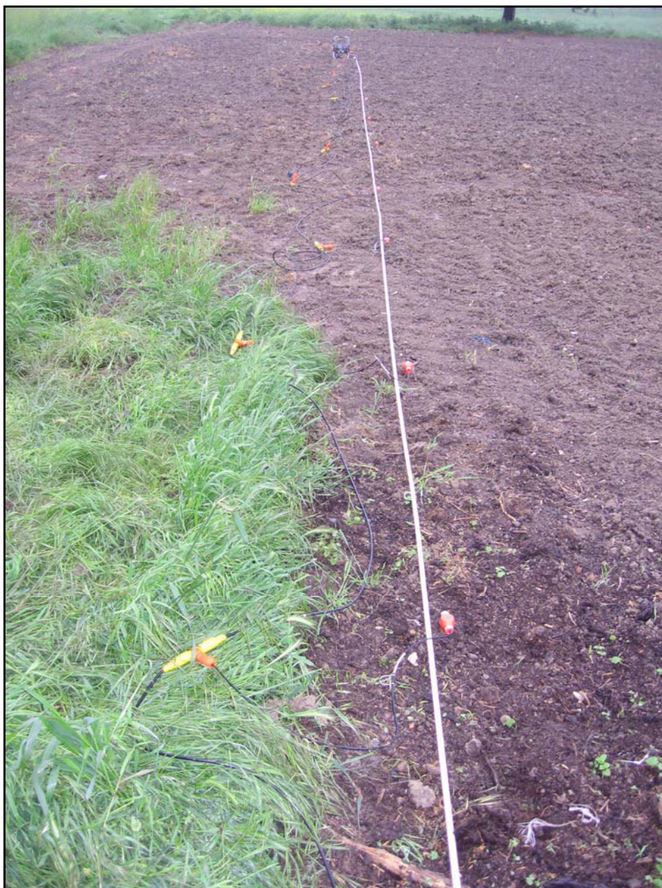
Figura 3: Vista dello stendimento MASW.
