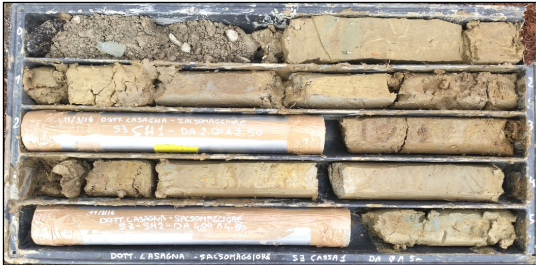
S3 - Cassetta da 0,0 a 5,0 m da p.c.
