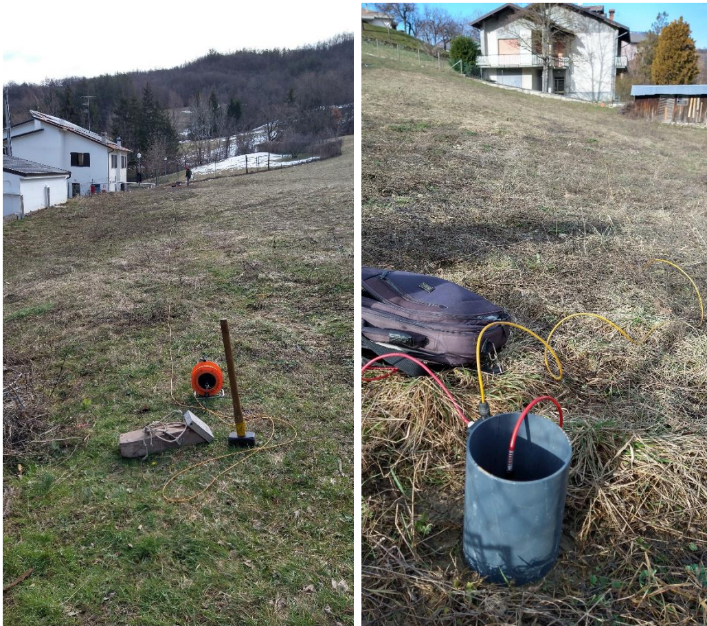
Figura A. 1 - Stendimento sismico MASW realizzato in corrispondenza dell'area di studio.
