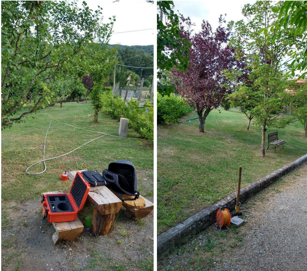
Figura A. 1 - Stendimento sismico MASW-HS realizzato in corrispondenza dell'area di studio.
