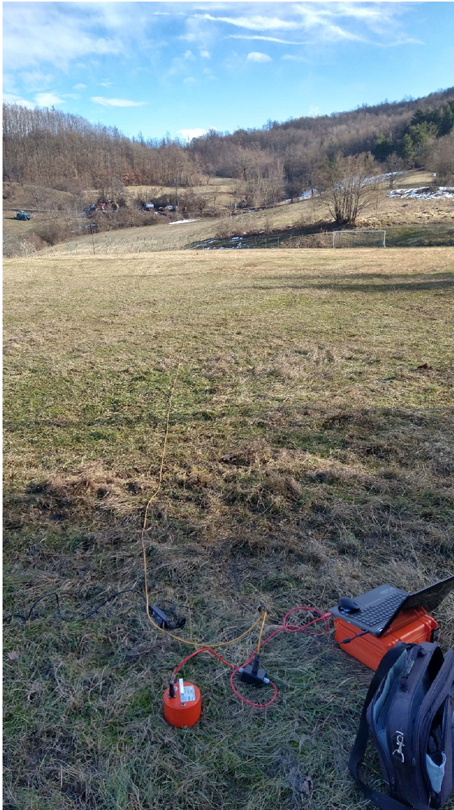
Figura A. 1 - Acquisizione HVSR realizzata in corrispondenza dell'area di studio.
