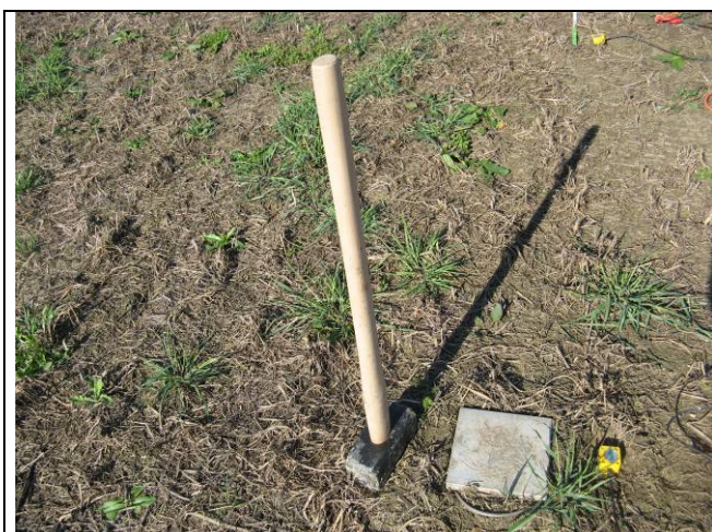
Sistema di energizzazione-battuta.
