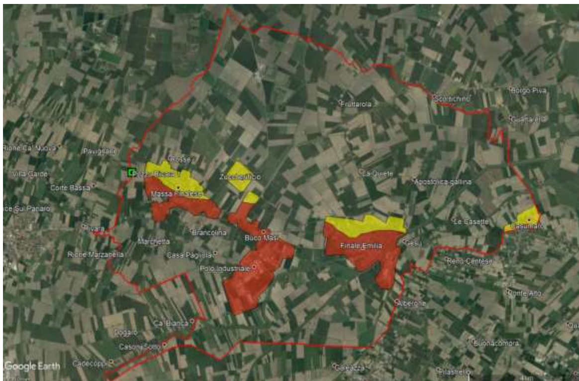
Figura 7-1: Aree del comune di Finale Emilia oggetto della microzonazione sismica a cui sono associate le due diverse modellazioni di risposta sismica locale: RSL1 (sud e sud-ovest) in arancione e RSL2 (nord e nord-est) in giallo.
