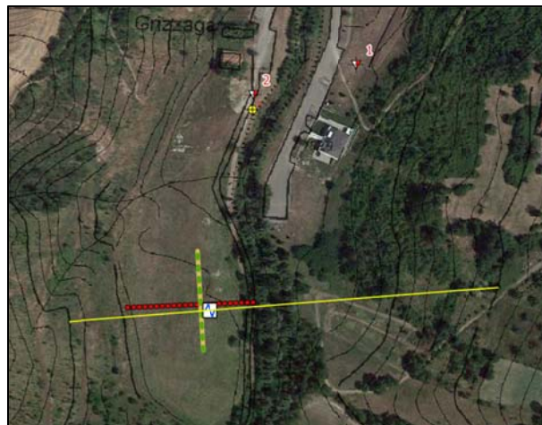
Figura 55 – La linea gialla indica la traccia del profilo di Figura 54 lungo il quale è stata effettuata l'analisi di risposta sismica locale 2D. Gli altri simboli indicano le ubicazioni delle indagini geognostiche e geofisiche realizzate nell'area per questo studio.
