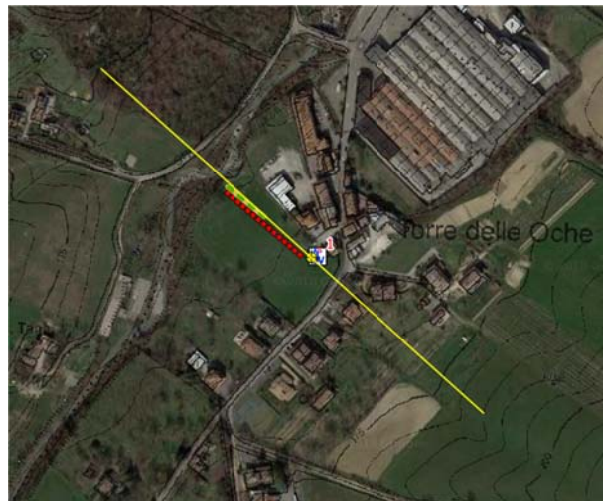
Figura 48 – L'alinea gialla indica la traccia del profilo di Figura 47 lungo il quale è stata effettuata l'analisi di risposta sismica locale 2D. Gli altri simboli indicano le ubicazioni delle indagini geognostiche e geofisiche realizzate nell'area per questo studio.
