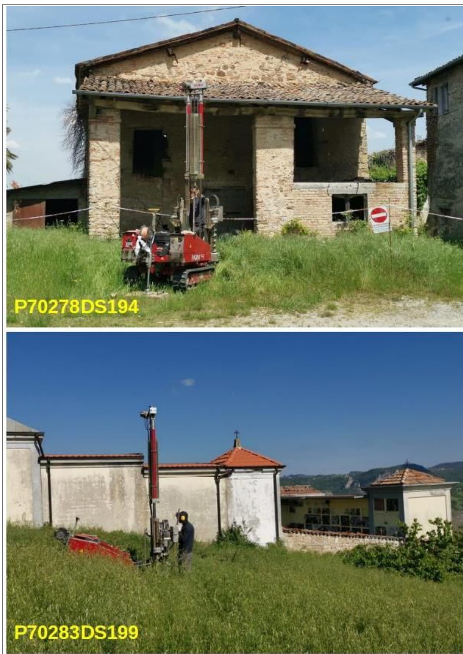
Foto 4.1 – Prove DPSH integrative eseguite nelle frazioni Denzano (in alto) e Festà Castello (in basso)
