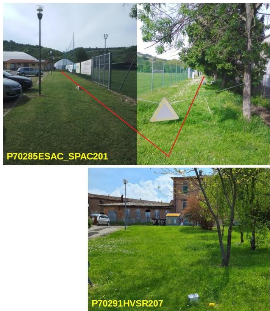
Foto 4.2 – Prove ESAC– SPAV e registrazione HVSR integrative eseguite nel Capoluogo (in alto) e nella frazione Ospitaletto (in basso)
