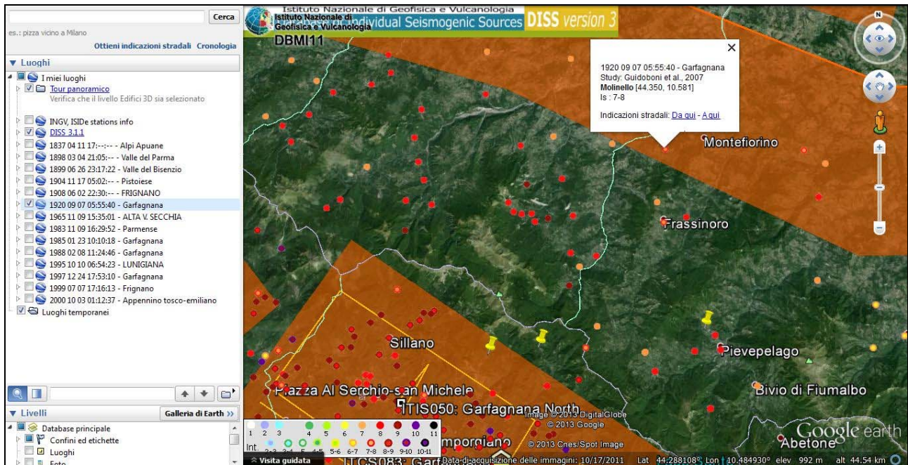
Figura 6 – Estratti dal database of Individual Seismogenic Sources (DISS) dell'INGV e dal DBMI11 (sovrapposti alla base Google Earth): i punti colorati si riferiscono alle intensità macrosismiche registrate in occasione del sisma del 7 settembre 1920 con epicentro in Garfagnana (più precisamente all'interno della sorgente sismogenetica composta ITCS083 "Garfagnana"). In basso a sinistra la scala delle intensità MCS).
