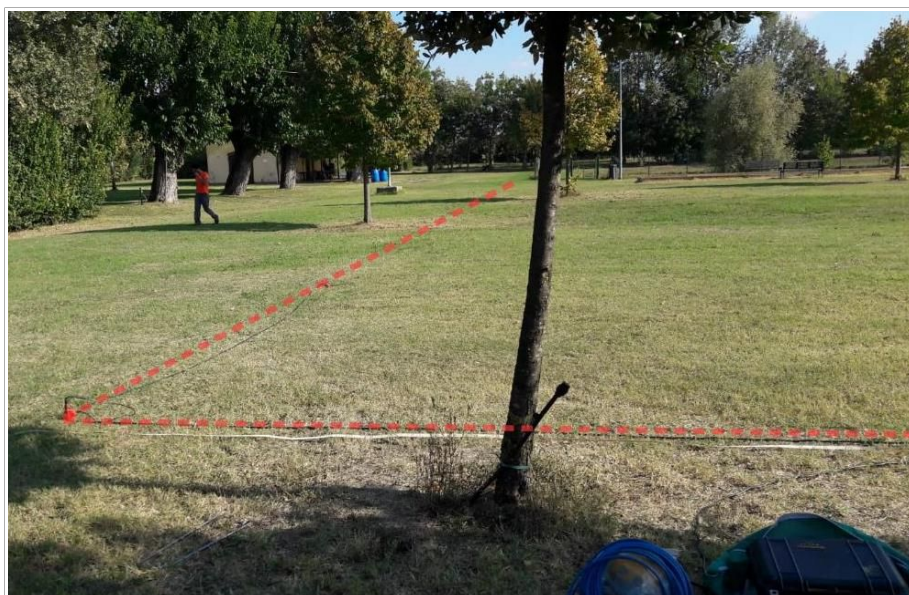
Foto 4.3 - Prova ESAC eseguita nella frazione S. Giacomo del Martignone
