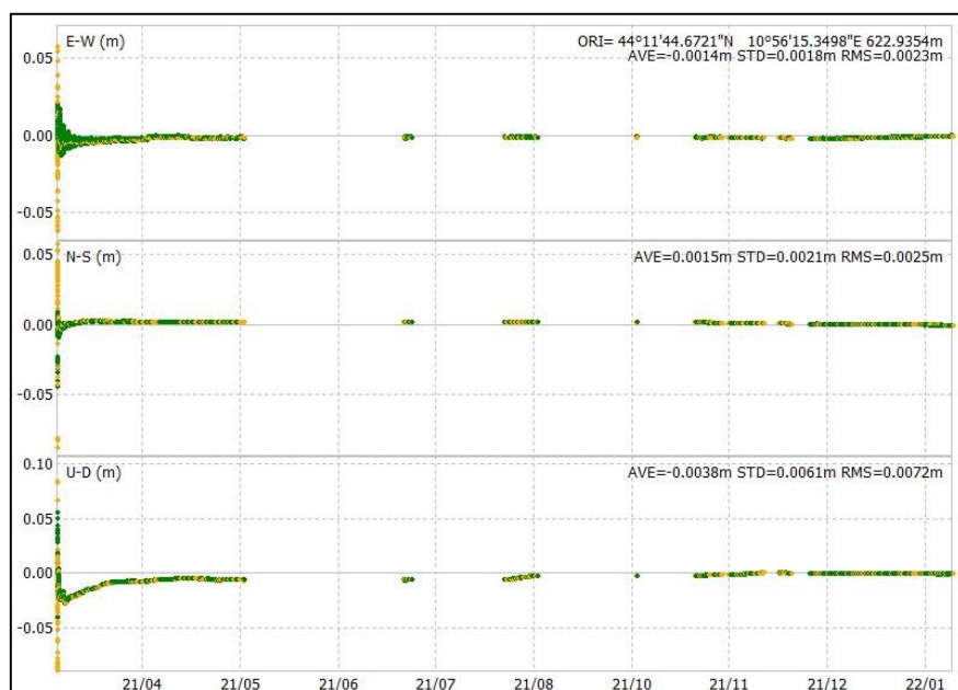
Fig. 6.7. Grafico con la posizione dei punti registrati con il Rover GPS localizzato presso Gaggio Montano tra l'11/03/2021 e il 25/01/2022. Nel grafico è presente una sintesi statistica delle misurazioni.
