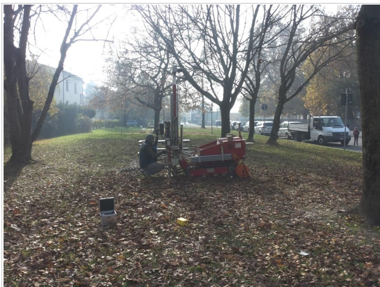
Foto 4.2 - Prova CPTU eseguita a San Venenzio con associata una registrazione sismica HVSr
