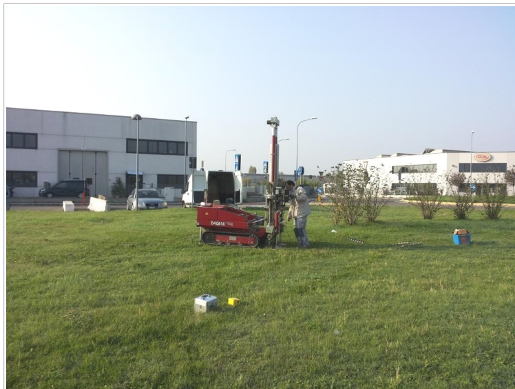
Foto 4.2 – Prova CPTU eseguita nella zona produttiva di Stiatico con associata una registrazione sismica HVSR
