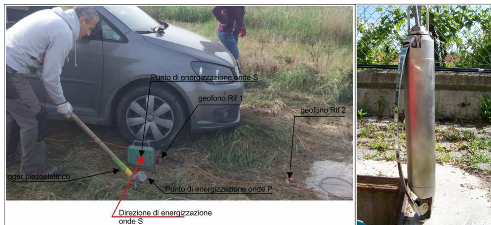
Foto 4.4 – prova “Down-Hole” e geofono utilizzato per le misure in foro
