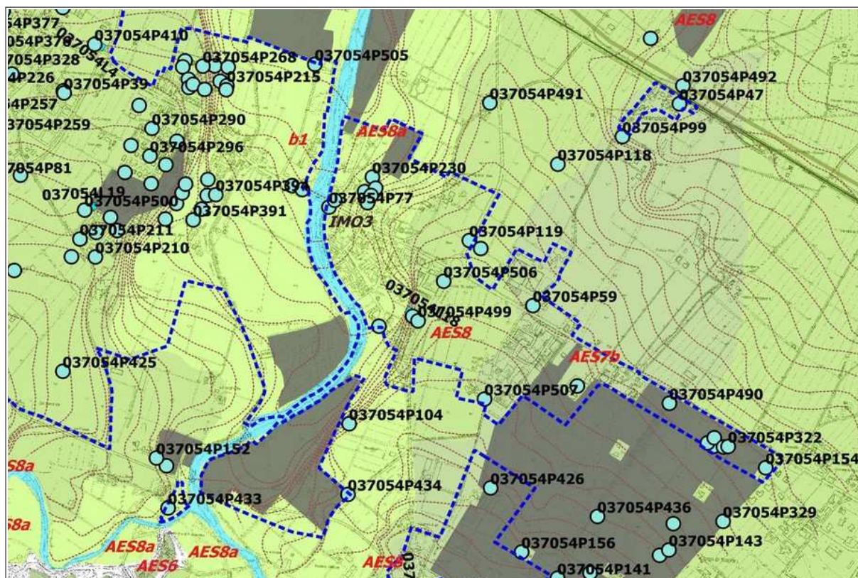
Figura 5.22- Aree di studio, coperture quaternarie e substrato geologico. La figura riporta le indagini geognostiche e geofisiche di riferimento
