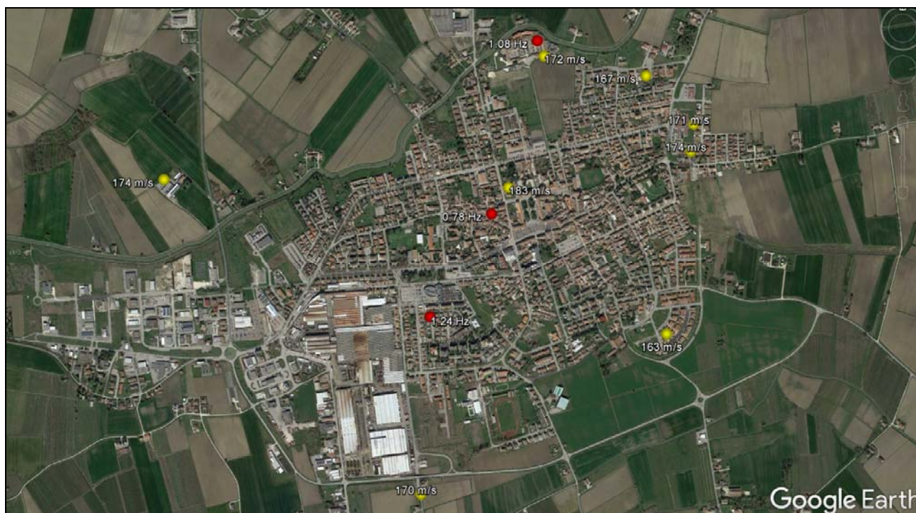
Figura 4.2-18: distribuzione areale delle principali frequenze di risonanza registrate nell'abitato di Copparo
