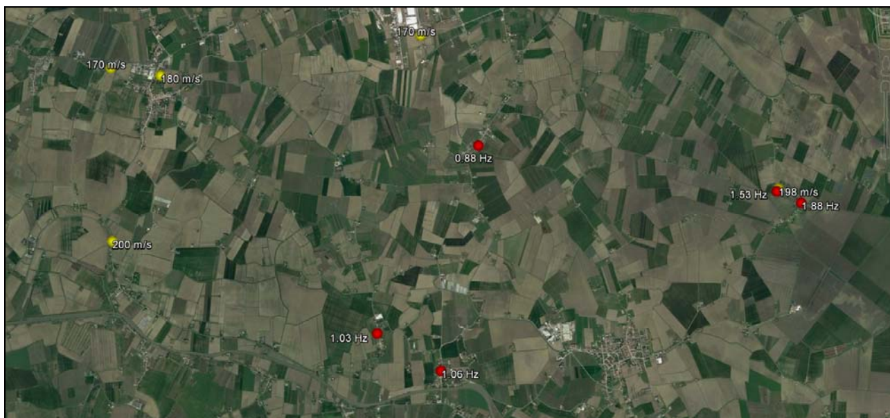
Figura 4.2-19: distribuzione areale delle principali frequenze di risonanza (pallino rosso) e Vs30 (pallino giallo) registrate nelle frazioni di Tamara, Fossalta, Sabbioncello San Pietro, Sabbioncello San Vittore, Gradizza e Brazzolo
