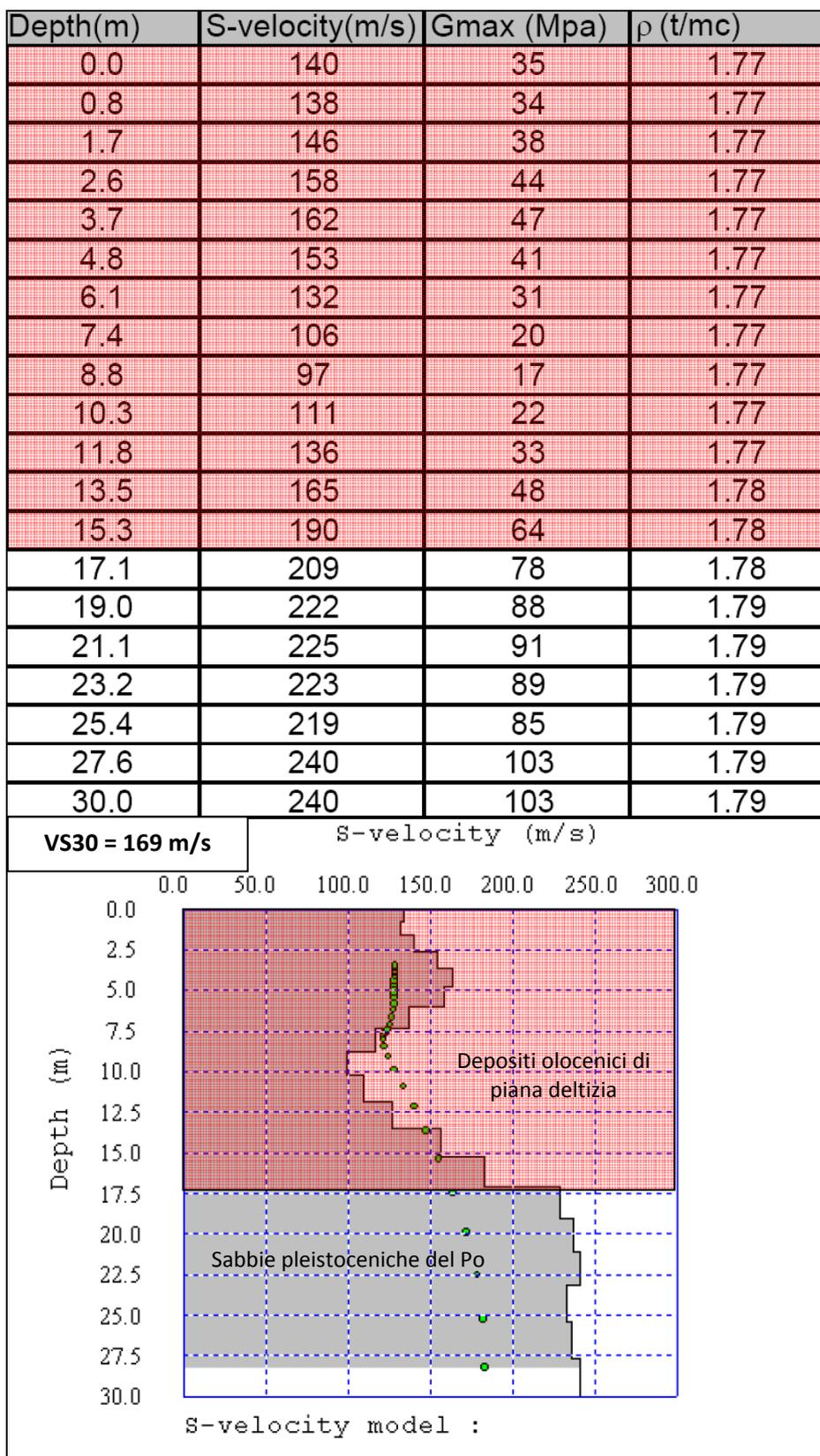
Figura 4.2-2: Modello di velocità delle onde di taglio S – 038009L2MASW2
