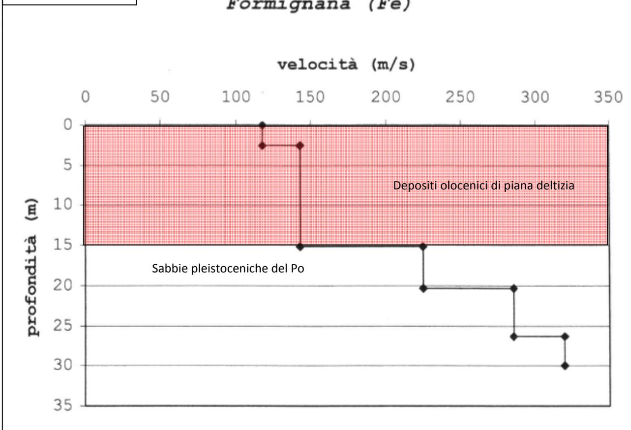
Figura 4.2-3: Modello di velocità delle onde di taglio S – 038009L3MASW3
