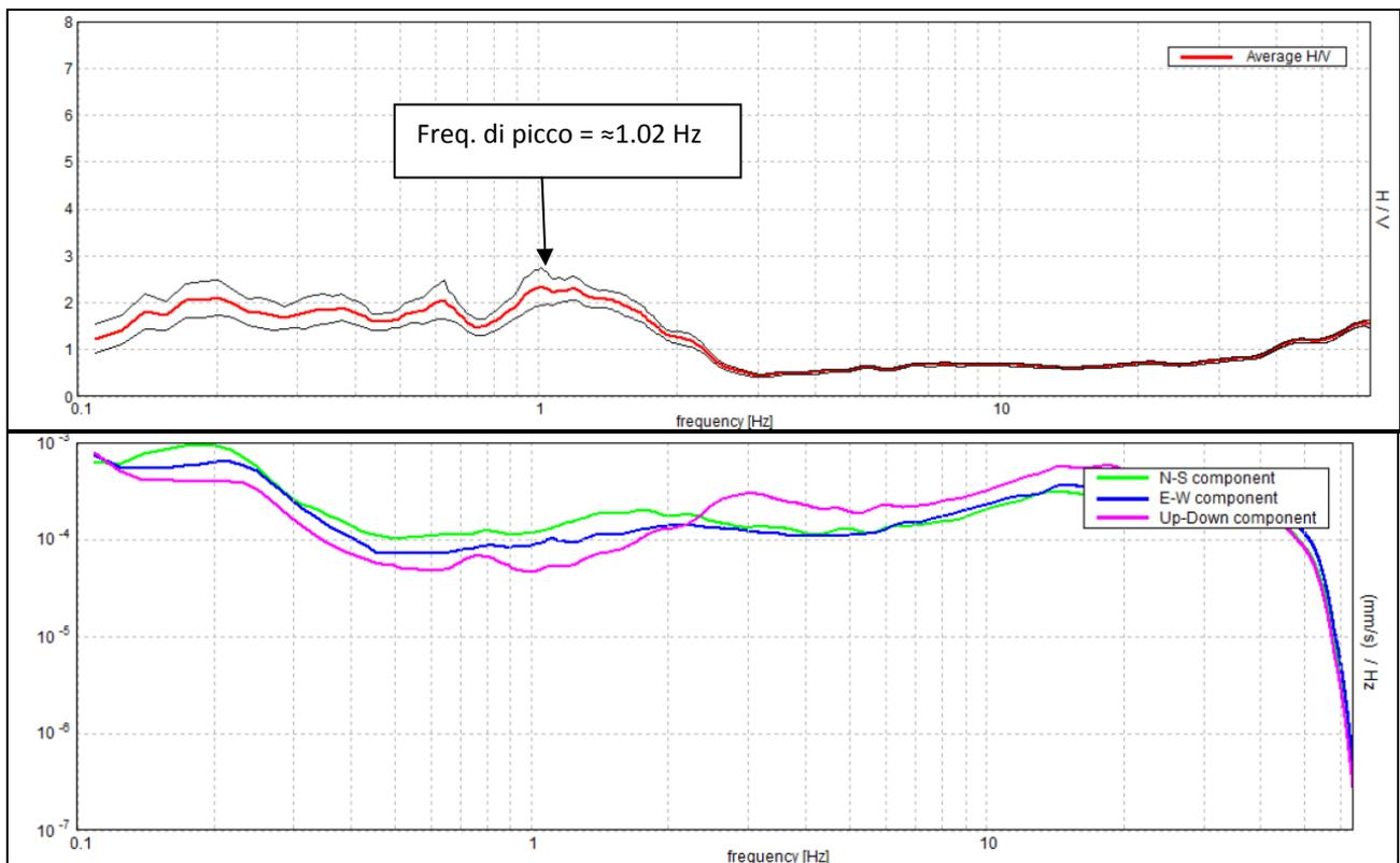
Figura 4.2-7: Curva sperimentale e singole componenti – prova nr. 038009P133HVS133
