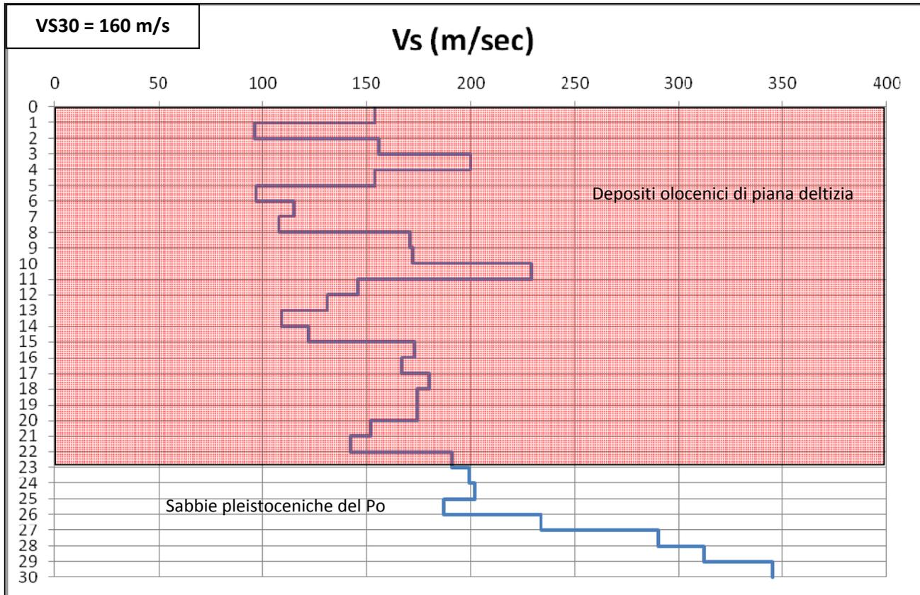
Figura 4.2-4: Modello di velocità delle onde di taglio S – prova nr. 038009P9SCPT9
