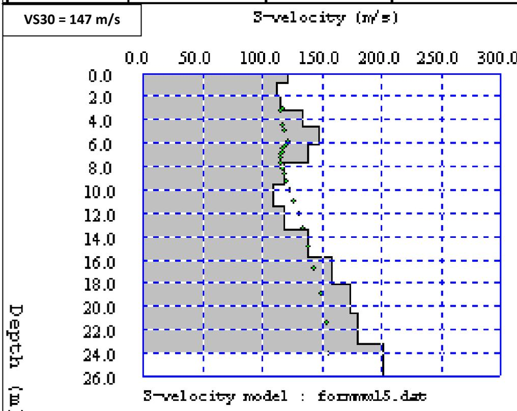
Figura 4.2-1: Modello di velocità delle onde di taglio S – 038009L1MASW1
