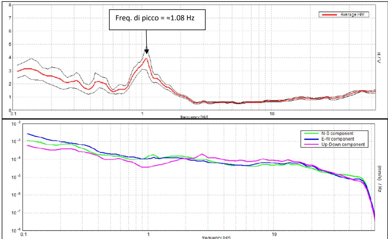
Figura 4.2-6: Curva sperimentale e singole componenti – prova nr. 038009P132HVS132
