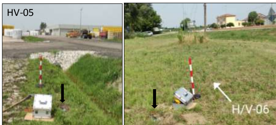
Figura 2: particolari prove dei rapporti spettrali "H/V" effettuate nell'area. A sinistra: HVSR-05 e a destra: HVSR-06 (Lagosanto, FE).
