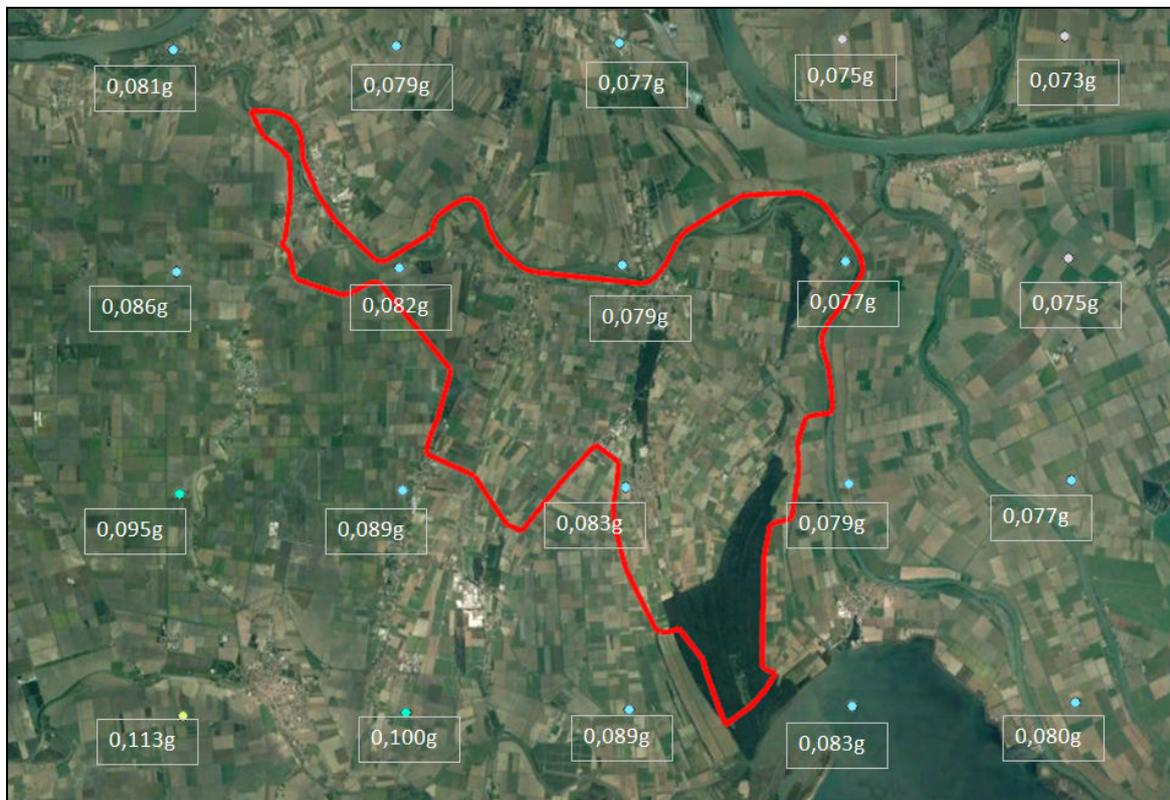
**Figura 2-33** - Accelerazioni PGA in superficie
