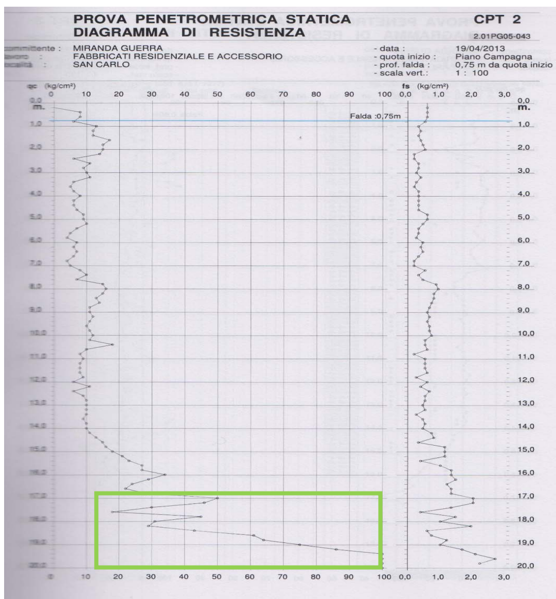
Figura 57– Esempio di rapporto di prova CPT effettuato ad ovest di San Carlo tra i due 'lobi' di LQ1. Il rettangolo verde evidenzia la presenza di un livello sabbioso di spessore maggiore di 2 m, a ca. 17 m profondità.
