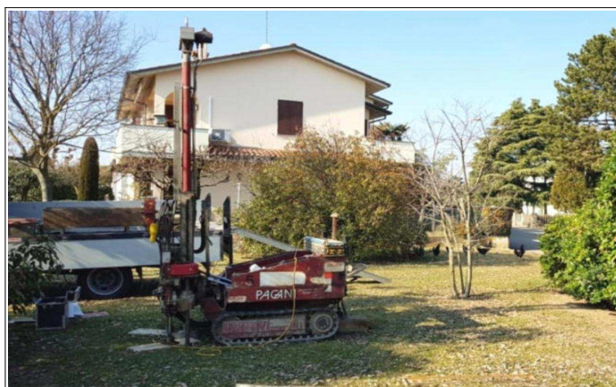
Foto 4.3 – Esecuzione della penetrometria CPTU con “Cono Sismico” all'angolo di via Serraglio con via Parini (prova P59166)
