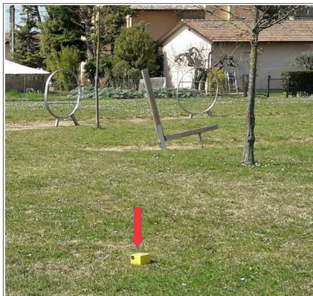
Foto 4.6 - Registrazione dei microtremori sismici eseguita per questo studio. La freccia rossa indica lo strumento in fase di registrazione
