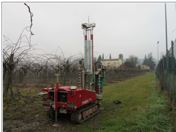
Foto 4.3 e 4.4 – Esecuzione delle prove DPSH nel terrazzo alluvionale presso Marzeno (a sx) e presso Oriolo dei Fichi (a dx).
