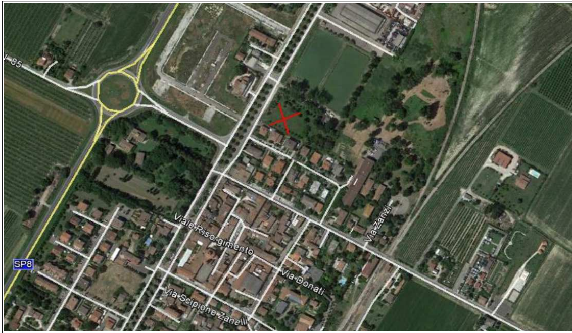
Foto 4.10 – Prova MASW/ReMi + ESAC eseguita nella frazione di Granarolo Faentino. La foto riprende la localizzazione dell'array bidimensionale disposto a “X”.
