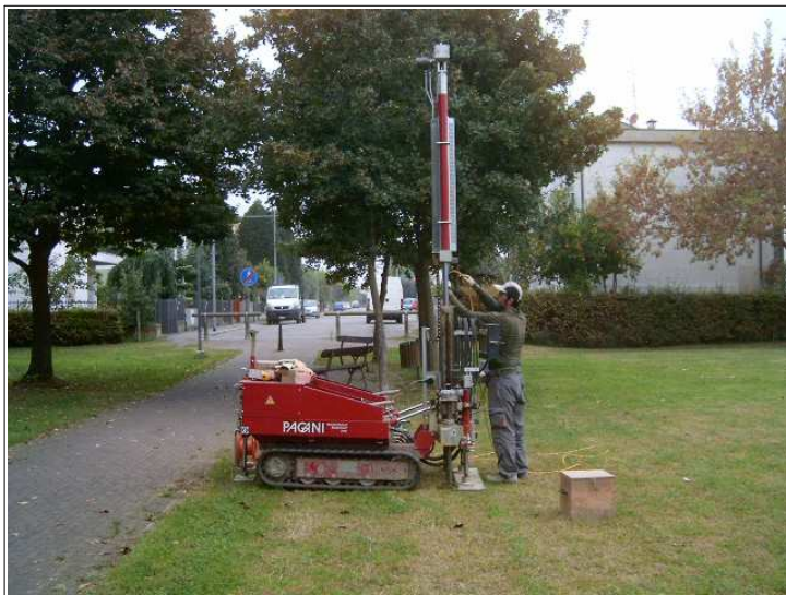
Foto 4.1 – Una delle prove CPTU eseguite nel Capoluogo (Piazza Giani).
