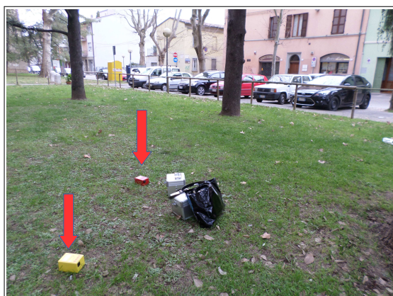
Foto 4.11 e 4.12 – Prove HVSR eseguite rispettivamente nel Capoluogo (nei pressi della stazione sismometrica "FAEN") e nella frazione di Granarolo (limitrofa alla prova CPTU P9SCPT16). Le frecce rosse indicano lo strumento in fase di registrazione.
