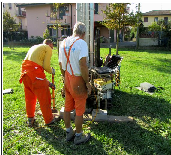
Foto 4.2 – Prova SCPTU eseguita nella frazione Granarolo.
