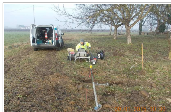
Foto 4.7 e 4.8 – Prove Down-Hole eseguite nei fori di sondaggio di Piazza del Popolo (a sx) e via Monte di Pietà (a dx).
