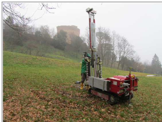
Foto 4.3 e 4.4 – Esecuzione delle prove DPSH nel terrazzo alluvionale presso Marzeno (a sx) e presso Oriolo dei Fichi (a dx).
