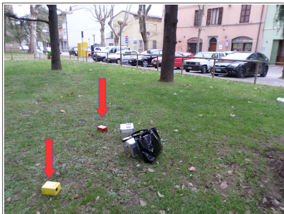
Foto 4.12 e 4.13 – Prove HVSR eseguite rispettivamente nel Capoluogo (nei pressi della stazione sismometrica "FAEN") e nella frazione di Granarolo (limitrofa alla prova CPTU P9SCPT16). Le frecce rosse indicano lo strumento in fase di registrazione.
