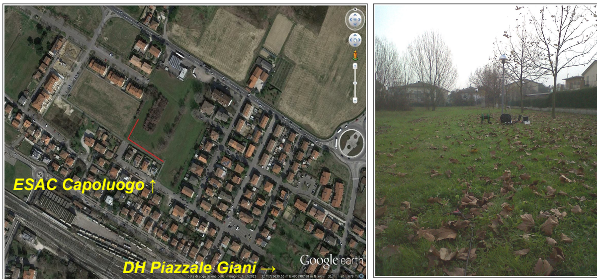
Foto 4.9 e 4.10 – Prova MASW/ReMi + ESAC eseguita nell'area Capoluogo. La foto riprende il lato più lungo dell'array bidimensionale disposto a "L".
