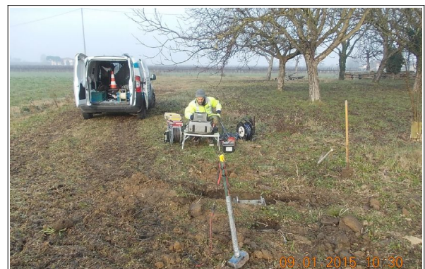
Foto 4.7 e 4.8 – Prove Down-Hole eseguite nei fori di sondaggio di Piazza del Popolo (a sx) e via Monte di Pietà (a dx).
