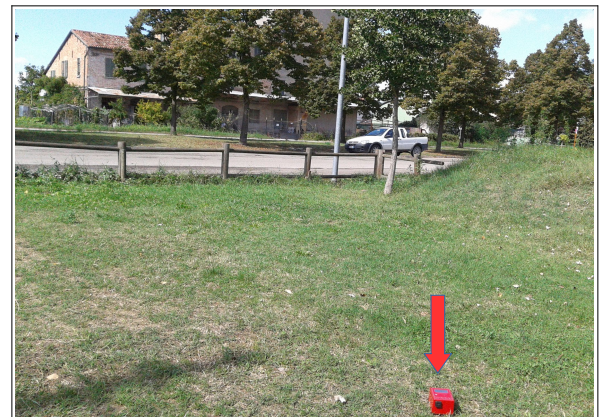
Foto 4.12 e 4.13 – Prove HVSR eseguite rispettivamente nel Capoluogo (nei pressi della stazione sismometrica "FAEN") e nella frazione di Granarolo (limitrofa alla prova CPTU P9SCPT16). Le frecce rosse indicano lo strumento in fase di registrazione.
