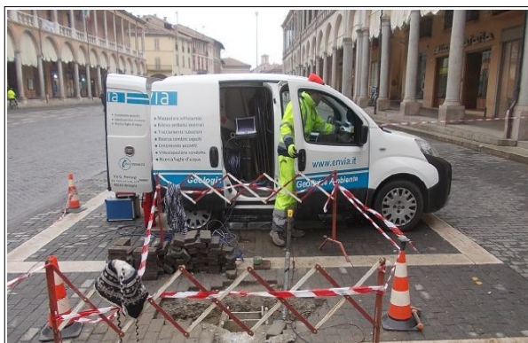
Foto 4.7 e 4.8 – Prove Down-Hole eseguite nei fori di sondaggio di Piazza del Popolo (a sx) e via Monte di Pietà (a dx).
