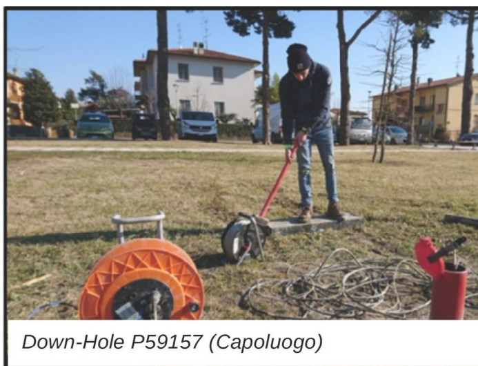
Foto 4.2 – Esecuzione della prova sismica in foro “Down-Hole” nel Capoluogo.
