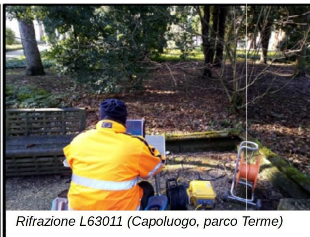
Foto 4.3 – Esecuzione degli stendimenti sismici a rifrazione nel Capoluogo.
