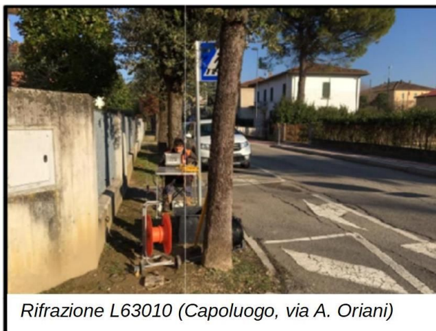
Foto 4.3 – Esecuzione degli stendimenti sismici a rifrazione nel Capoluogo.
